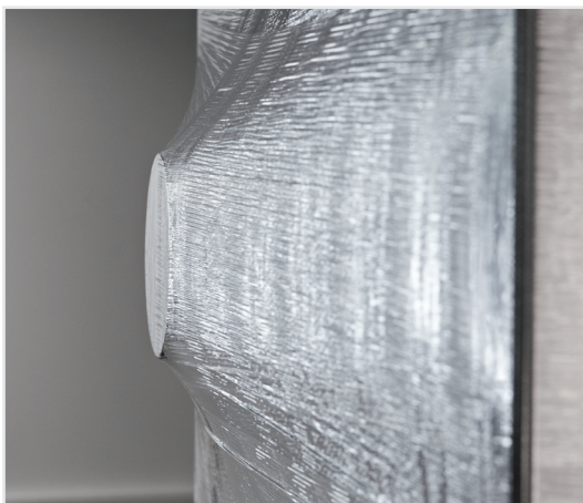
Elastisch herstel Terugstelkracht volgens ASTM D4649-03
